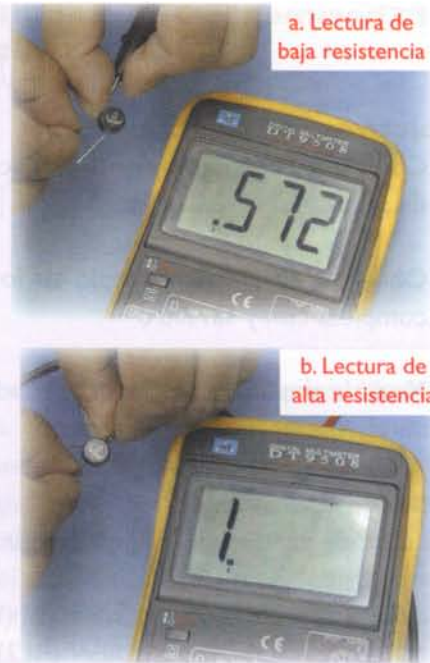
Figura 7.65. Probando el puente rectificador
